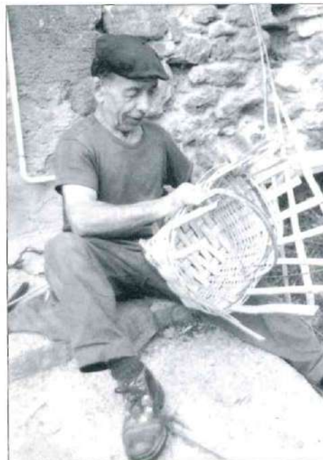
Le panier est pratiquement terminé, il ne manque que la coupe juste des montants et le rabat à l'intérieur.
