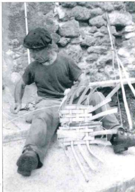
Montage du fond et imbrication de l'anse dans la trame.
