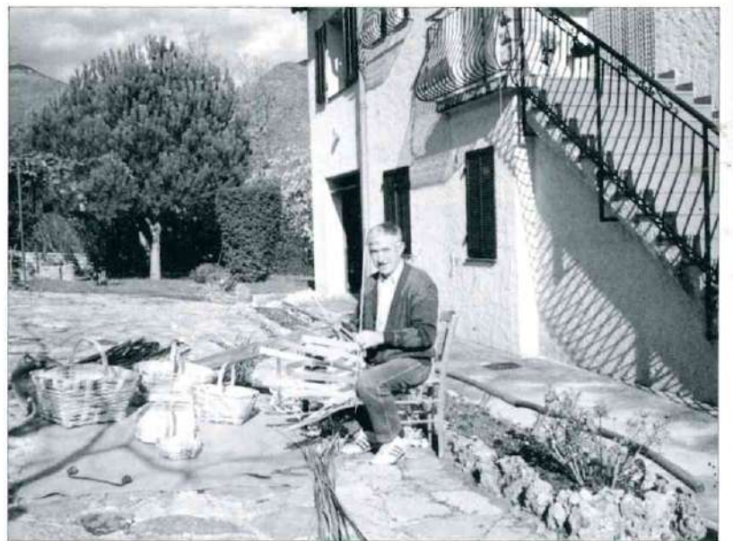
Ce cliché nous permet de voir le montage des "limas" pour confectionner un panier. L'outil posé sur le sol à gauche est la "plane" utilisée pour calibrer les montants du panier. Photo R. Truchi
